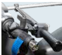
Bevestiging van de frameklem met kruisklem aan het stuur
