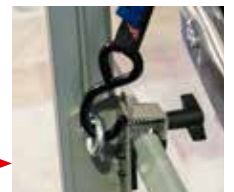
Twee sjaorogen aan de bevestigingsbeugel
