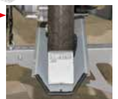
Wielkeg bevestigd op de motorgoot
